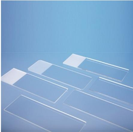
**Vetrini portaggetti prodotti con vetro extra bianco. Forma rettangolare, dimensioni standard di 26x76mm e spessore di 1mm. Provvisti di doppia banda smerigliata, consistente in una superficie porosa di circa 20mm che permette una facile scrittura.**
